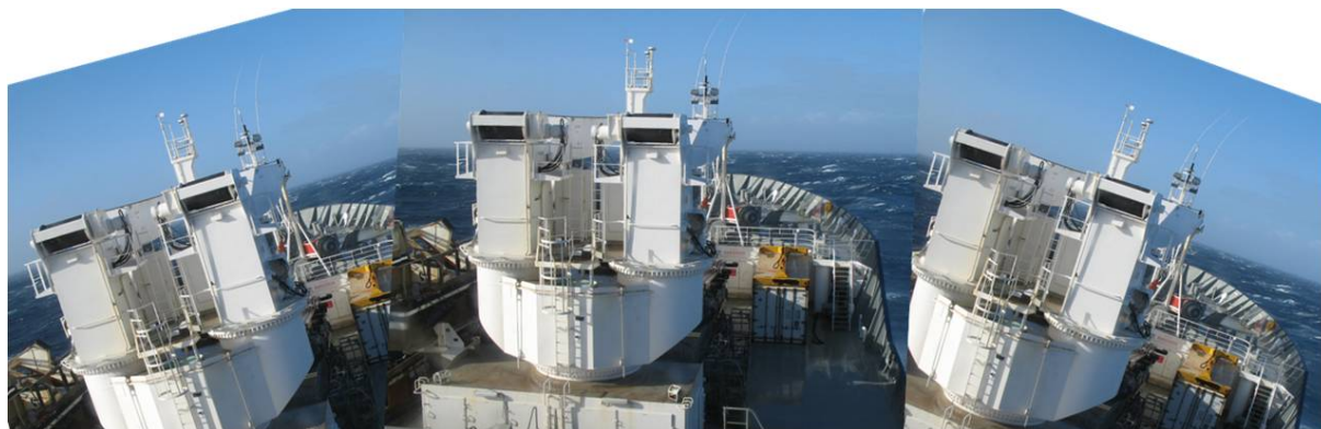
Fig. 1 - Tentative d'illustration du roulis à bord du Marion Dufresne. Le roulis est un mouvement d'oscillation du bateau de gauche à droite, alors que la tangage est un mouvement d'oscillation dans le sens de la longueur, l'avant et l'arrière du bateau s'enfonçant alternativement (photo M. Lebouvier)
